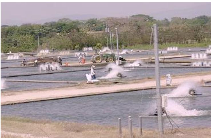
Sistema de aireación , con aireadores de paletas (1,9 a 2,2 kg. de O<sub>2</sub> por kwh), en estanques hexagonales con piso y paredes de concreto.
